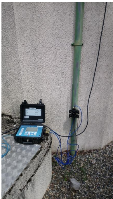
Photos n°1 et 2 : mise en place d'un débitmètre sur une conduite d'arrivée en entrée de station et d'un préleveur automatique sur un canal de rejet lors de la réalisation d'une autosurveillance réglementaire
