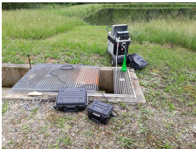
Photos n°1 et 2 : mise en place d'un débitmètre sur une conduite d'arrivée en entrée de station et d'un préleveur automatique sur un canal de rejet lors de la réalisation d'une autosurveillance réglementaire
